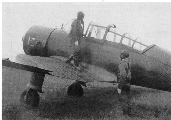
【写真③】 太刀洗陸軍飛行学校における九九式高等練習機。胴体側面の写真用窓、風防のアンテナ支柱がなくなっているのが分かる。発動機カウリングの「に」は、機体固有識別子であろう。
