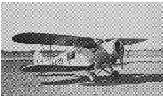
【写真⑩】上はKS-1（登録記号 J-AARD）で、海と空—日本飛行機年報一九四〇年から。下は機種不明も、立川飛行機発行の当時の絵葉書から。正面の風防が分割されているのがお分かりいただけるだろうか。また、木製ベラであることも分かる。
