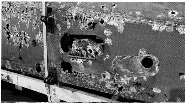
【写真3】 展示機と附図第23「主翼結合部」。すなわち、胴体中央翼と外翼の結合部の構造で、左は上が胴体側、下が外翼側（下に示した附図の○囲い部分）。その材質は「イ202鍛」というもので、これも前掲した航空評議会の規格名。イは「棒鋼、鋼片、鍛造品」の細則で、イ202は一般的には強靱鋼と言われるもの、「イ202鍛」は抗張力75kg/mm<sup>2</sup>のクロムモリブデン鋼である。それと胴体側の金具とを貫通する主翼の結合ボルト（テーパボルト）は「イ201棒」（抗張力80kg/mm<sup>2</sup>のクロム鋼）製。この部分は通常は見ることができない箇所であり、またこれだけで機体と主翼を繋いで空を飛んでいるのである。じっくりと観察したい。
