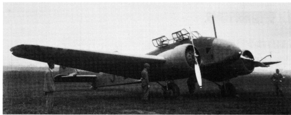
【写真2-16】 朝日新聞社の「南進号」。九三式双軽爆撃機二型から民間機に改造された機体である。
