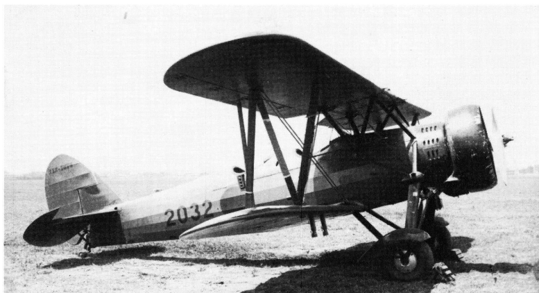
【写真3-4】 昭和16年11月までの機種別生産機数第1位(1,829機)の九五式一型練習機(当時のプロマイドから)。同機の量産型は2001号機からとされており、本写真の機体はその32号機にあたる初期型(後の甲型)である。本機の発動機は後述する瓦斯電(後の日立航空機)製の九五式350馬力発動機(「天風」系列)で、同社が立川工場を設けてからの生産機は東京府「北多摩郡」製の飛行機と言えよう。
