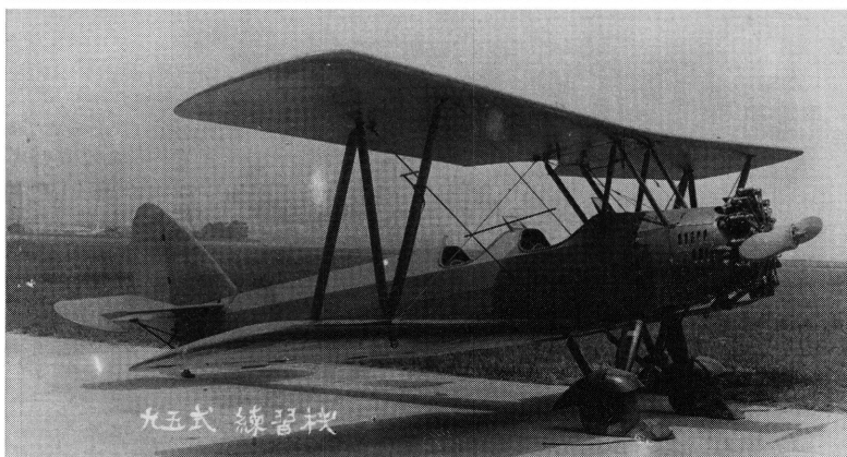
【写真3-6】 同機種別生産機数第4位(380機)の九五式三型練習機。本機も瓦斯電(後の日立航空機)製の発動機を積んだ「北多摩郡」製機だが、本機のエンジンは、九五式150馬力発動機(「神風」系列)。石川島飛行機製作所の創立以来、試作を重ねてきた練習機は本機と同等クラスのもので、軍用機としてはあったが完成をみた。ただし、創立期の目標はその練習機に搭載する発動機込みの量産であり、それはついに叶わなかった。
